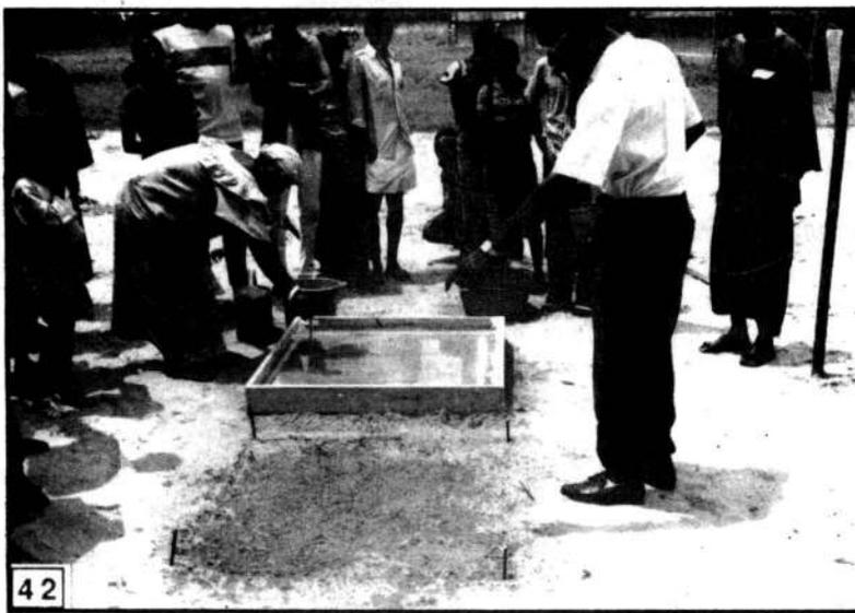
*Approchons-nous maintenant du caisson. La surface est de un mètre carré. Versons-y une couche d'eau. Au moyen d'une règle millimétrée de l'école dont nous avons coupé soigneusement*
