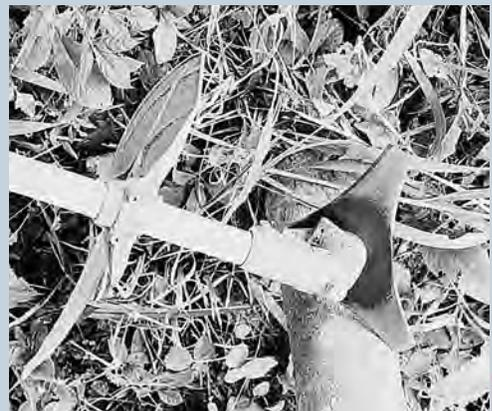
*Une débroussailleuse mécanique et sa lame triangulaire.*
